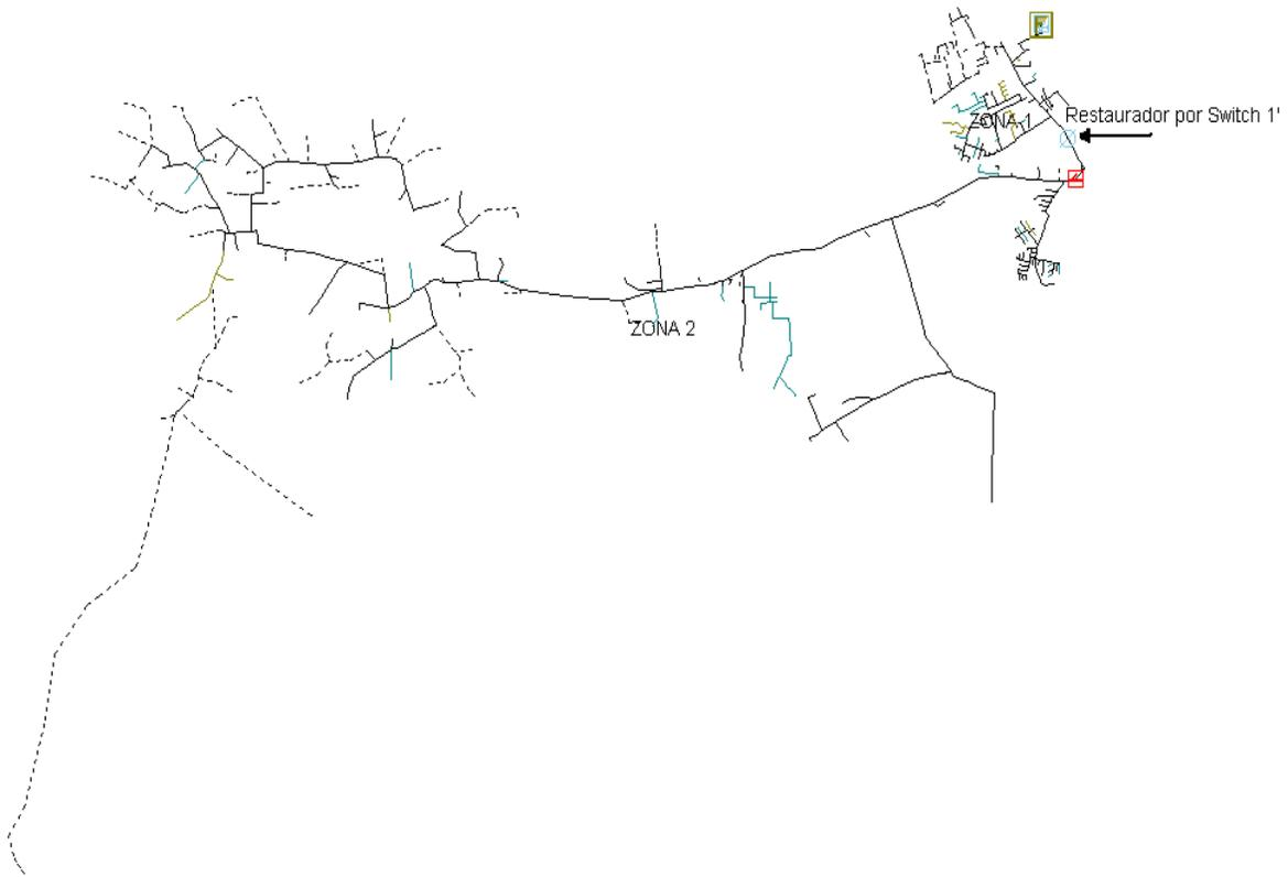
Figura 4.14 Alimentador OAP04020 para su configuración de sustitución del switch 1' por un restaurador [18].
